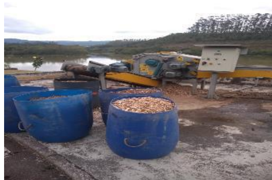
Foto 12 - Resíduos lenhosos retirados da tomada d’água, após triturados são destinados para áreas de APP.
